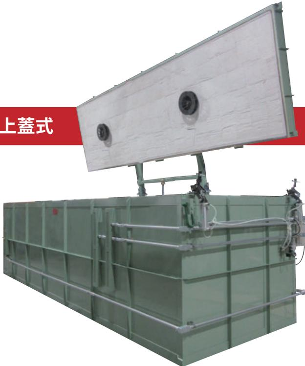
這種結構常用於希望從上方放入工件以及放入重載荷工件的情況。
